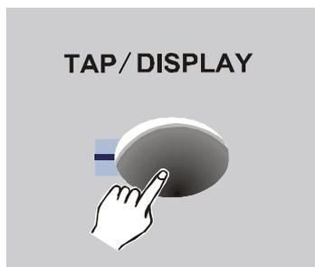
**Tap/Sync:** Es wird die Ablaufgeschwindigkeit des Speed Regler überschrieben. Dabei gibt der Takt von zweimaligem Drücken dieser Taste die Geschwindigkeit vor (Min. 1 Step pro 10min.). Im Display erscheint die so bestimmte Next-Time.
