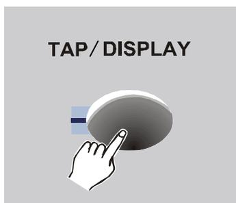
4. Mit der Tap/Display Taste wählen Sie zwischen den HIGH bzw. LOW Kanälen des Gerätes.
