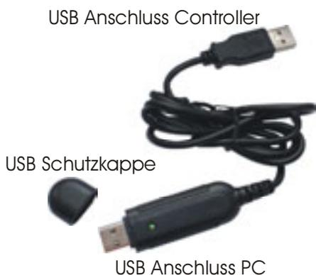
1. Verbinden Sie den Controller mit Hilfe des ULink Adapterkabels mit dem Computer. Achten Sie auf die Richtige Zuordnung der Steckverbindungen → siehe Bild.
