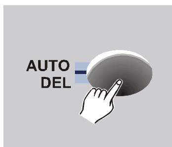
5. Drücken Sie die Auto/Del Taste um den entsprechenden Step zu löschen. Als Speicherbestätigung blinken alle LEDs drei mal auf.
